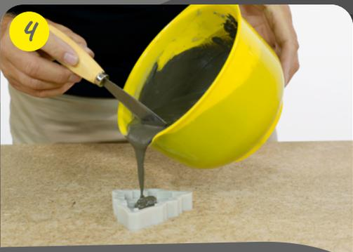
4 Anschließend füllt ihr den flüssigen Beton in die Silikonformen.
